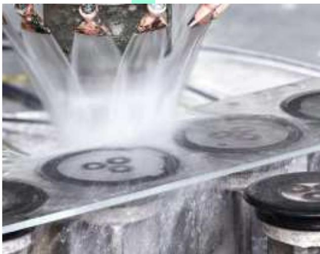
Prodotto liquido a **base di poliammine cationiche** in grado di formare **flocchi voluminosi** che catturano le particelle di sfrido, portandole sul fondo.
